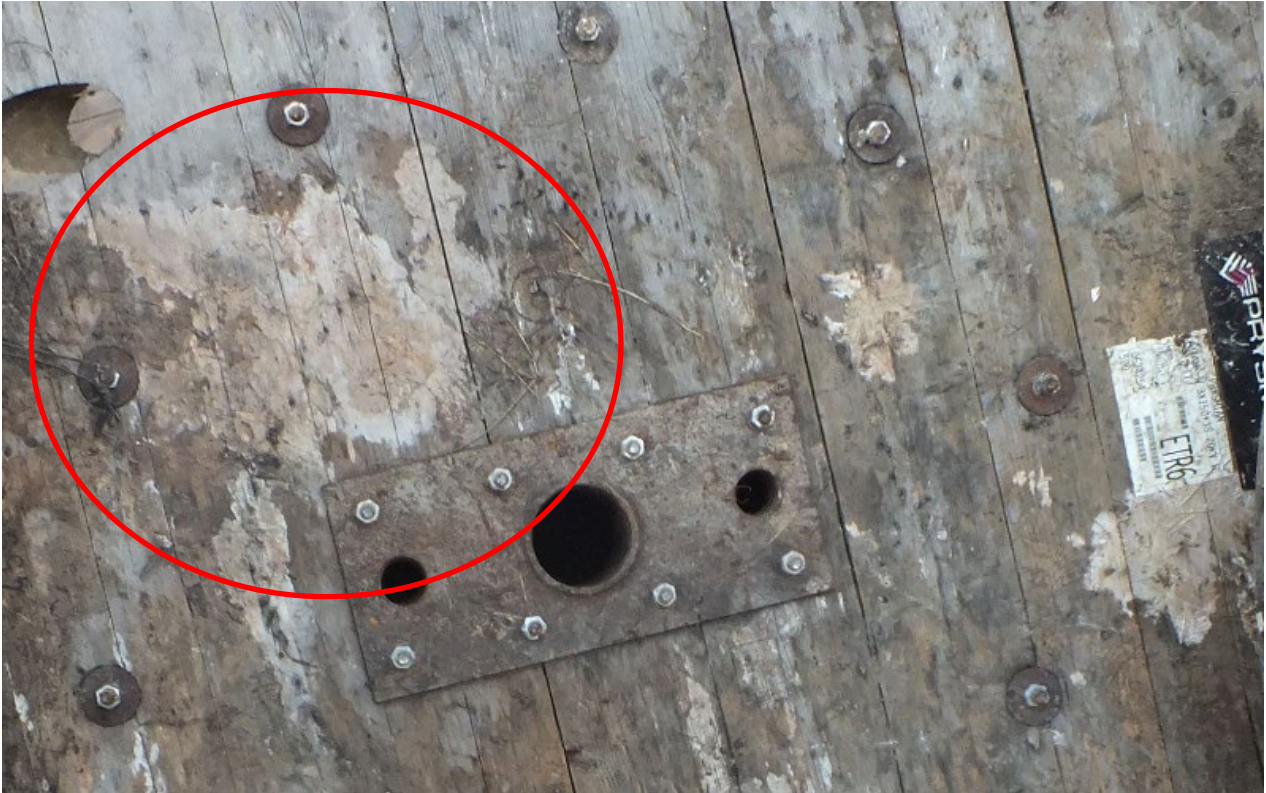
KUVA 7, KP = KELAN PUHTAUS; KELAA ON SÄILYTETTY LAPPEELLAAN MAASSA JA SIIHEN ON KIINNITTYNEENÄ MAA-AINEKSIA MUUTOSHISTORIA
