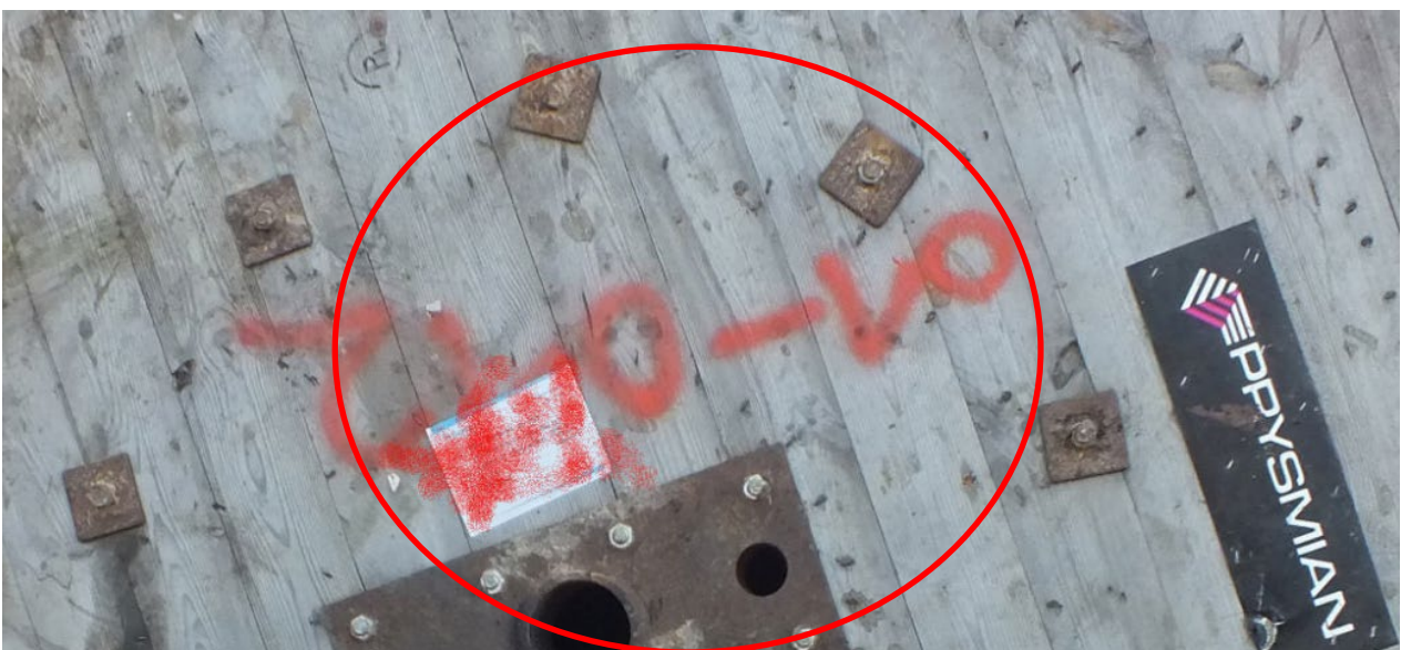
KUVA 6, KP = KELAN PUHTAUS; KELA ON SOTKETTU MAALILLA TMS.
