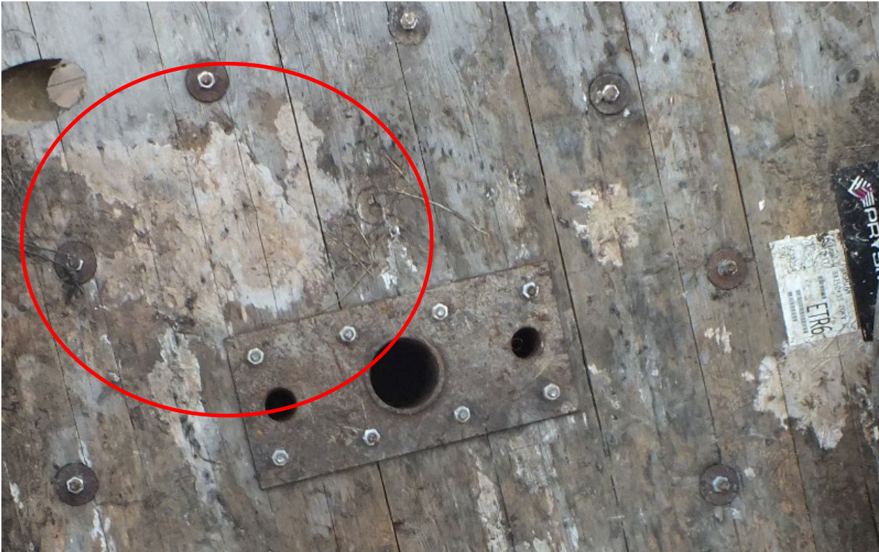
KUVA 7, KP = KELAN PUHTAUS; KELAA ON SÄILYTETTY LAPPEELLAAN MAASSA JA SIIHEN ON KIINNITTYNEENÄ MAA-AINEKSIA.
